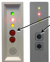
Pritisnite tipko »Izklop zvoka« in držite pritisnjeno, dokler indikator »Alarm« ne prične hitro utripati, nato spustite. Vrednost tesnosti je prikazana na naslednji način:
