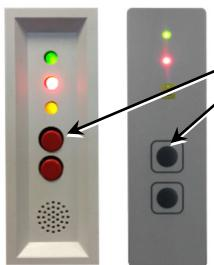
Pritisnite in držite tipko »Izklop zvoka« (približno 10 sekund). Alarm se sproži, dokler tipke ne spustite.
