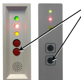
Na kratko pritisnite gumb »Potrditev sporočila o suhem filtru«, da izklopite zvočni signal. Optični prikaz (ostane izmenično utripanje rdeče in rumene lučke LED).
