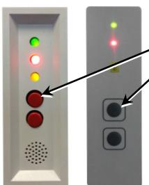
Enkrat na hitro pritisnite tipko »Izklop zvoka«, zvočni signal se izklopi, rdeča lučka LED utripa.
