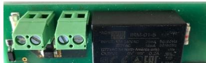
S+/S- Povezava s kontaktom sonde na glavni plošči tiskanega vezja
