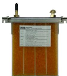
Um Korrosion durch Kondensatansammlung im Überwachungsraum zu vermeiden, ist der Leckanzeiger LDU14 mit einem Trockenfilter ausgestattet. Mit der zusätzlichen Trockenfilterüberwachung FC wird sichergestellt, dass der Verbrauch des Filters erkannt wird und ein Austausch des verbrauchten Trockenmaterials erfolgt.
