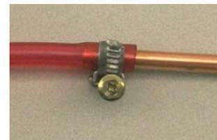
1. Glisser la bride ou la bague de fixation sur le tuyau
