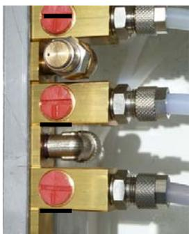
Collettore di distribuzione dei serbatoi "Pressione" con valvola di sicurezza per sovrappressione e valvole aperte
