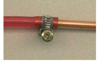
1. Draht- oder Schraubschelle über Schlauch schieben
