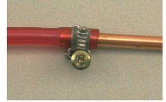
1. Draht- oder Schraubschelle über Schlauch schieben
