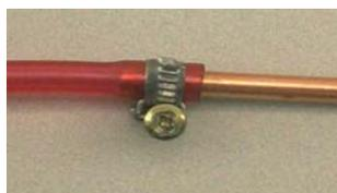
1. Draht- oder Schraubschelle über Schlauch schieben
