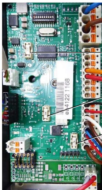
Fusible 2 A für 24-V-Stromversorgung Platine
