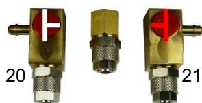
Tourner le robinet à trois voies 21 de 90° dans le sens horaire à partir de la position de service. L'alarme se déclenche, la pompe se met en marche.
