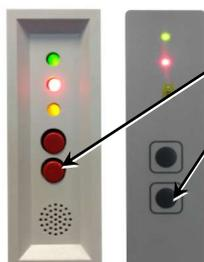
Appuyer brièvement sur la touche « Acquiescement de l'alarme filtre déshydrateur » pour couper le signal sonore. L'affichage visuel (clignotement alterné des LED rouge et jaune) est maintenu. Pour réinitialiser complètement l'alarme de filtre déshydrateur, maintenir la touche enfoncée jusqu'à ce qu'un signal sonore retentisse.
