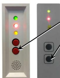
Premere brevemente il tasto "Tacetazione messaggio filtro a secco", in maniera da disattivare il segnale acustico. L'indicatore ottico (il lampeggio alternante del LED rosso e giallo) rimane attivo.
