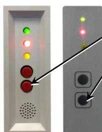
Pulsar brevemente el botón «Confirmar el aviso del filtro desecante», de este modo se desconectará la señal acústica. La visualización óptica (se mantiene el parpadeo recíproco de los LED amarilla y roja).
