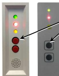
Pulsar el botón «Desconectar tono» y mantenerlo pulsado (aprox. 10 segundos), se activa la señal de alarma hasta que se suelte de nuevo.
