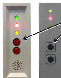
Pulsar el botón «Desconectar tono» y mantenerlo pulsado hasta que el indicador luminoso «Alarma» parpadee rápidamente, después soltarlo. Se muestra un valor para estanqueidad de la siguiente manera:
