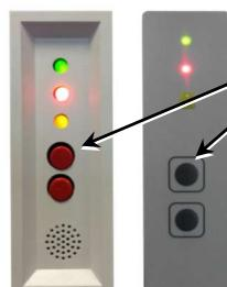
Tryk på tasten "lyd fra", og hold den nede, indtil lysmelderen "alarm" blinker hurtigt, og slip den så igen. En værdi for tæthedens vises på følgende måde:
