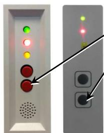
Tryk kort på tasten "kvittering tørfiltermelding", hvorefter det akustiske signal slukkes. Den optiske visning (den røde og gule LED blinker skiftevis) fortsætter.
