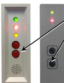
Appuyer sur la touche « Remplissage » et la maintenir enfoncée pendant environ 5 sec. jusqu'à ce que la LED jaune clignote. Le processus de remplissage est activé.
