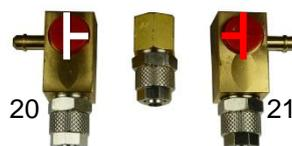
(8) Tourner les robinets à trois voies 20 et 21 pour les ramener en position de service. Retirer l'instrument de mesure et de contrôle.
