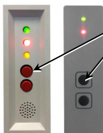
Taste „Ton aus“ einmal kurz drücken, akustisches Signal schaltet ab, die rote LED blinkt.
