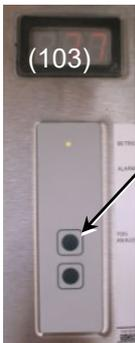
Taste „Ton aus“ drücken und gedrückt halten bis der Leuchtmelder schnell blinkt, dann loslassen. Ein Wert für die Dichtheit wird auf dem Display (103) angezeigt, der gleiche Wert wird durch Aufblinken des Leuchtmelders „Alarm“ ausgegeben.
