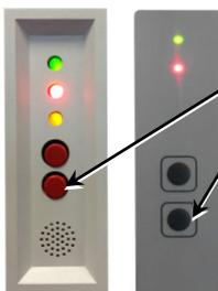
Taste „Füllen“ drücken und für ca. 5 Sek. gedrückt halten, bis die gelbe LED blinkt. Der Füllvorgang ist aktiviert.
