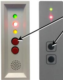
Taste „Ton aus“ drücken und gedrückt halten (ca. 10 Sek.), die Alarmgabe wird ausgelöst, bis die Taste wieder losgelassen wird.
