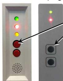
Pulse brevemente el pulsador "Alarma acústica", la señal acústica se apaga y el LED rojo parpadea.
