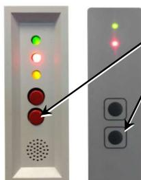
Pulsar brevemente el pulsador "Confirmar el aviso del filtro desecante" para que se desconecte la señal acústica. La visualización óptica (se mantiene el parpadeo recíproco de los LED amarilla y roja).
