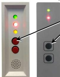
Accione el pulsador "Alarma acústica" y manténgalo pulsado (aprox. 10 segundos), se activa la señal de alarma hasta que se suelte de nuevo.
