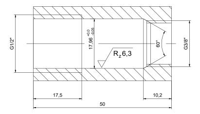
Anstelle des G3/8"-Gewindes kann das Gehäuse auch alternativ mit einem G1/8"-Gewinde bezogen werden. Die Gewindetiefe von 10,2 mm sowie alle anderen Maße bleiben in beiden Varianten erhalten.
