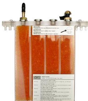
Ein Trockenfilter trocknet die angesaugte Luft, um mögliche Kondensation und Korrosion im Überwachungsraum zu vermeiden. Das Trocknungsmaterial zeigt die Sättigung durch Farbumschlag von Orange nach Weiß an. Ausgelegt ist der Trockenfilter für ein Jahr bei Einhaltung des bestimmungsgemäßen Gebrauchs beziehungsweise bei ausreichender Dichtheit des Systems.
