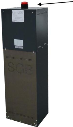
Ein Alarm eines der Leckanzeigesysteme im LDU14 wird optisch und akustisch angezeigt. Es ertönt ein akustisches Signal. Der potentialfreie Relaiskontakt öffnet. Optional leuchtet eine Blitzleuchte auf dem Gehäuseoberteil.
