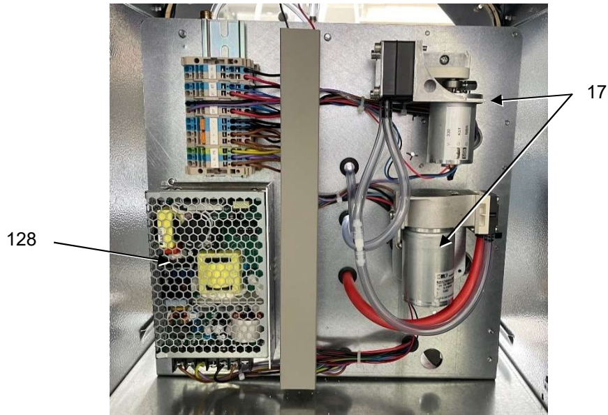
17 Pompa a sovrappressione, serbatoio sopra e tubazione sotto 128 Alimentatore di comando
