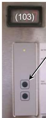
Premere e tenere premuto il tasto “Mute” fino a quando la spia luminosa non lampeggia rapidamente, poi rilasciare il tasto. Un valore per la tenuta viene visualizzato sul display (103), lo stesso valore viene emesso per il numero di volte che la spia luminosa “Allarme” lampeggia.
