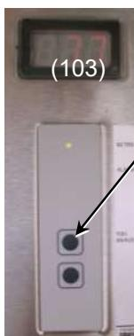
Tryk på tasten "lyd fra", og hold den nede, indtil lysmelderen blinker hurtigt, og slip den så igen. En værdi for tæthed vises på displayet (103), den samme værdi udsendes via antallet af blink for lysmelderen "alarm".
