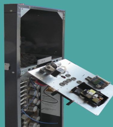
Più comodità: Accesso alla parte posteriore attraverso la piastra di montaggio piastra di montaggio incernierata anteriormente
