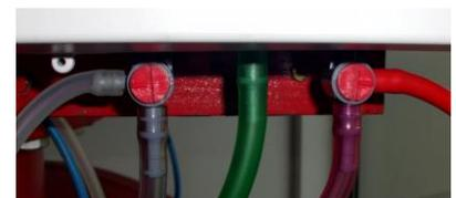
Mit **zwei** Dreiwegehähnen für eine einfache Funktionsprüfung
